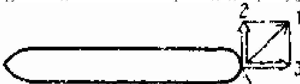
Рис. 13 Влияние руля: 1 — сила на пере руля; 2 — поперечная сила; 3 — продольная сила, снижающая скорость судна
