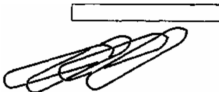
Рис. 41. Эффект носового подруливающего устройства
